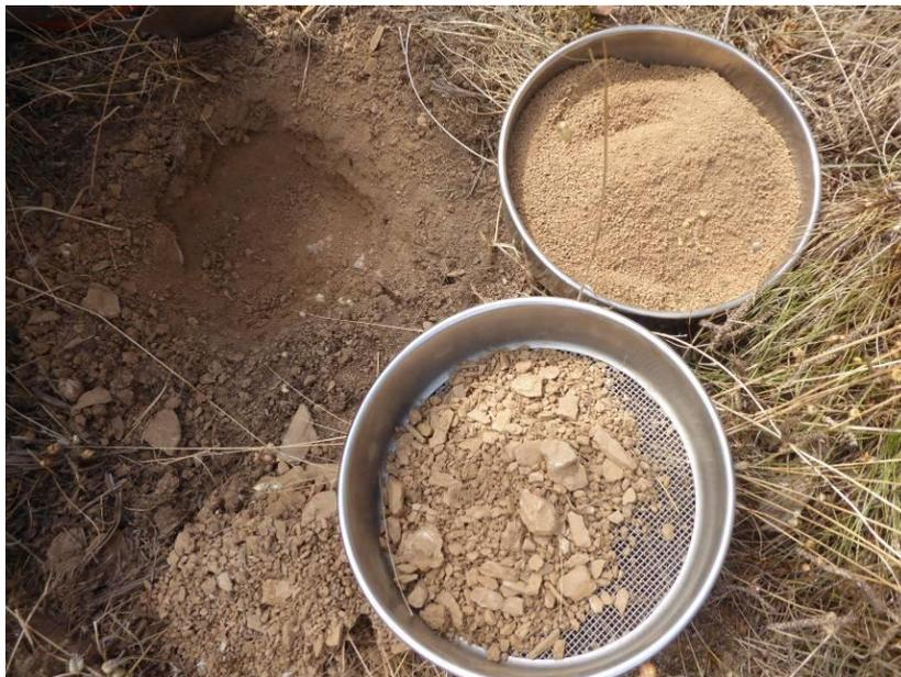
Figure 5 : Exemple d'un prélèvement de sol tamisé à 2 mm.
